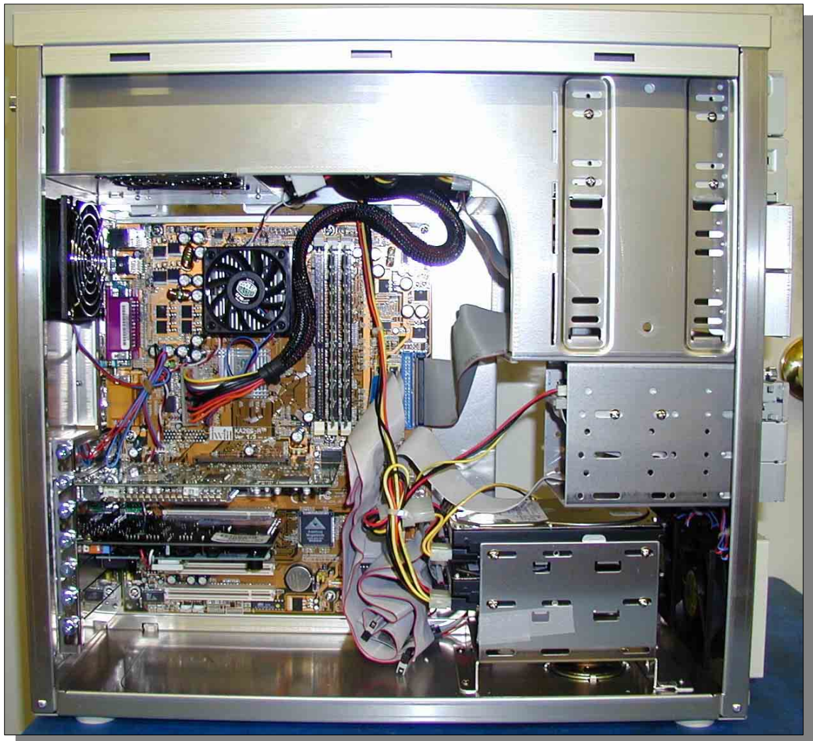
Figura 3.10: Vista interior del gabinete de una PC.
